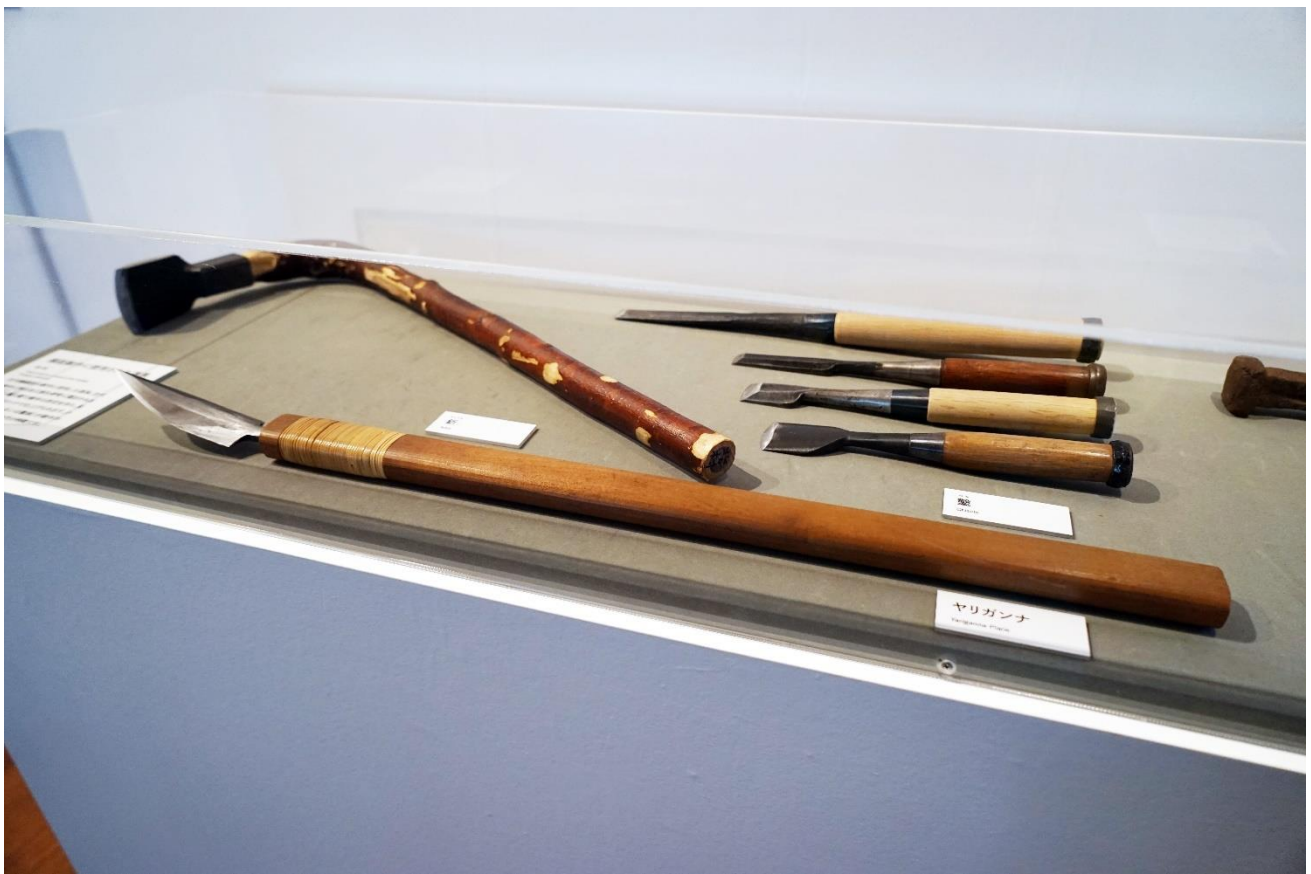
こちらは古代の鎌継ぎの再現展示と、製作に使用したチョウナ・ヤリガンナ・ノミ。 唐招提寺の鎌継ぎをサンプルに、古材に残る加工痕を参考にして、大工道具にもこだわって製作しました。
