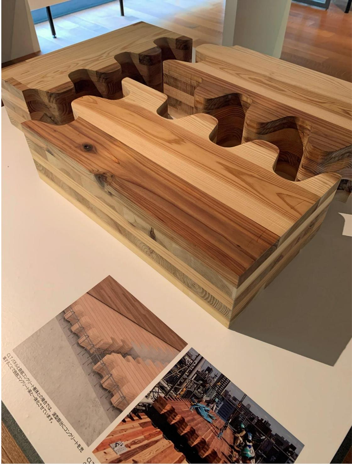
CLTパネルと鉄筋コンクリート構造との接合では、液状部分にコンクリートを充填することで両者の一体化が図れます。
