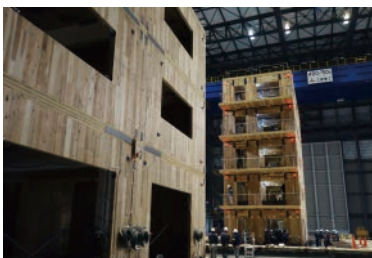
CLTの集合住宅振動台実験試験体
