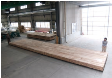
日本での製造最大サイズのCLT
