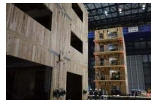
7 | CLT の集合住宅振動台実験試験体
