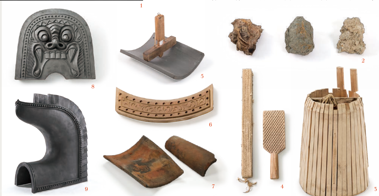
1 東大寺大仏殿昭和修理 | 2 原材料の土 (左から腐木、田土、山土) 3、4 古代瓦の製作用具 (一部) | 5 瓦の選別道具 | 6 軒平瓦の木型 7 元興寺の瓦 | 8 東大寺の鬼瓦 | 9 唐招提寺金堂の鴟尾 * 3、4、6、8、9は復元品
